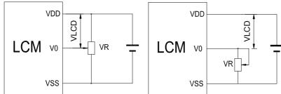
$V_{\text{DD-}}V_0\text{: LCD Driving voltage} \quad VR\text{: } 10k\text{--}20k$
